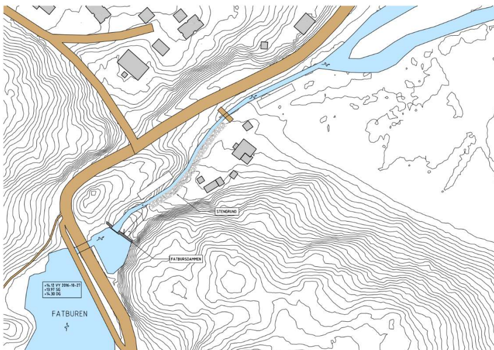
Figur 22. Befintlig utformning Fatbursdammen, PLAN. Norconsult 2016.
