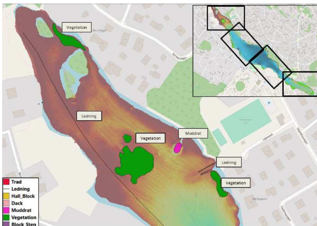
Figur 3. Tolkade strukturer från sjömätning i norra delen av Långsjön, utförd av Clinton 2020. I den nordvästra delen påträffades ledningar, vegetation och muddrat område vid en brygga.
