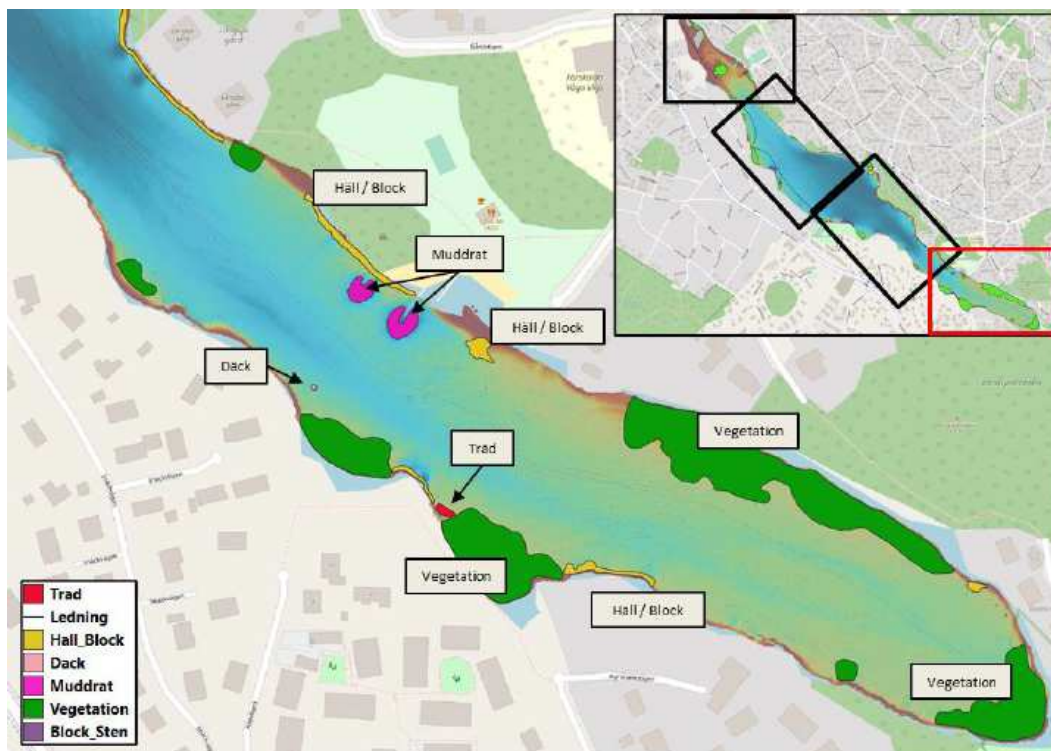
Figur 6. Tolkade strukturer från sjömätning av Långsjön, utförd av Clinton 2020. I den södra delen påträffades muddrade områden utanför bryggorna vid badplatsen, ett större däck, träd, vegetation, hållar och block.
