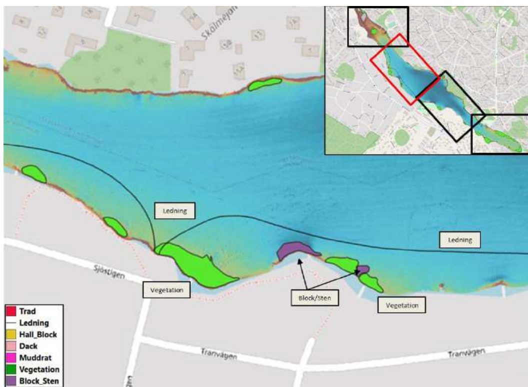
Figur 4. Tolkade strukturer från sjömätning av Långsjön, utförd av Clinton 2020. I den nordliga mellersta delen påträffades ledning, block och sten, samt vegetation.
