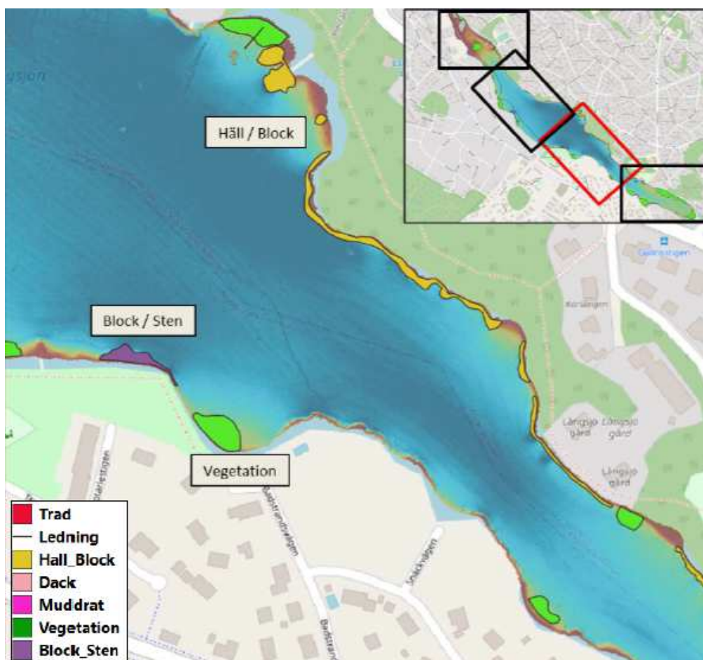
Figur 5. Tolkade strukturer från sjömätning av Långsjön, utförd av Clinton 2020. I den södra mellersta delen påträffades, ledning, muddrat område, block, häll och sten.
