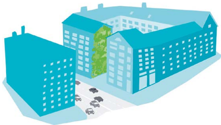
Bullerreducering med vegetation på husfasad.
