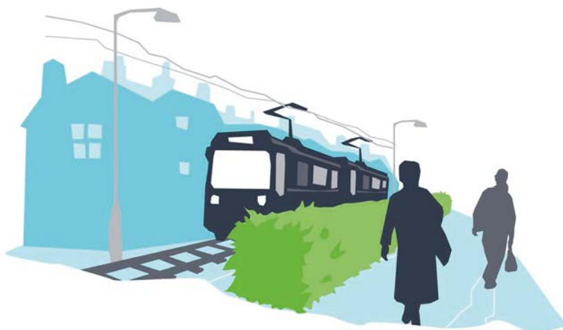
Låg, akustiskt absorberand skärm.
