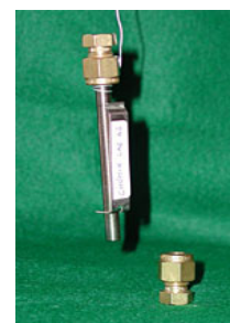
Figur 5:4 Tenaxrör för provtagning av flyktiga organiska ämnen,
