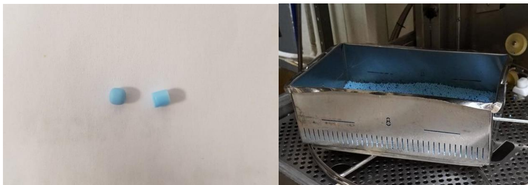
Bild 3. Sliten respektive ny granul samt förvarings/upsamlingstråg för granulerna.
