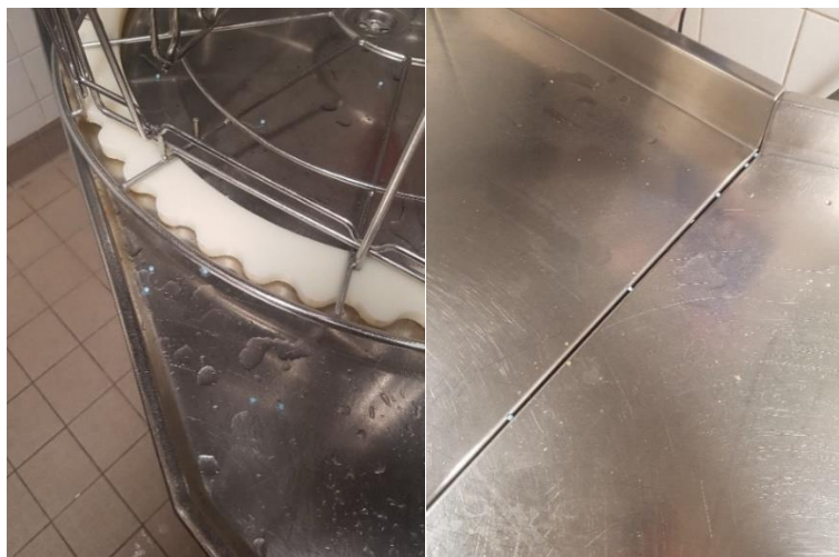
Bild 6. Granuler som flytt med diskgodset ut på arbetsbänken
