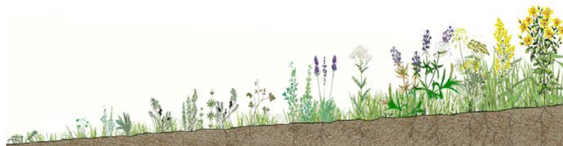
Med ett större jorddjup har fler växter möjlighet att etablera sig och överleva torrperioder på gröna tak. Källa: Gröna takhandboken
