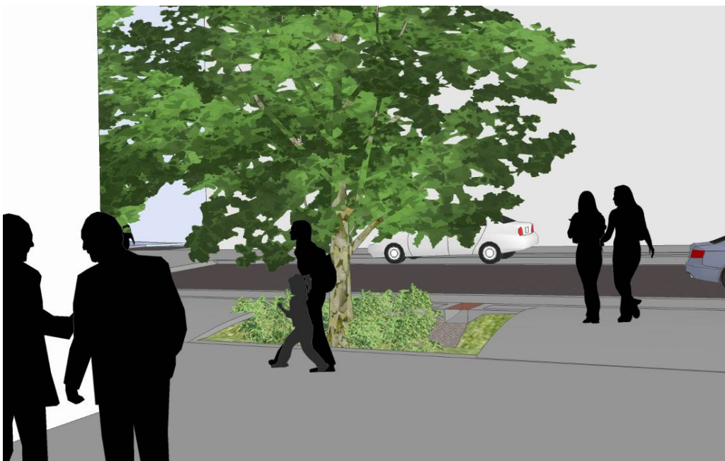
Bild 3. Lokalgata. Inloppen mynnar ytligt vid anlagt erosionsskydd. Gångbana avrinner mot växtbädden.
