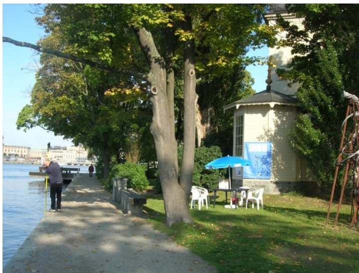
Figur 3.1. SMHIs havspegel (mareograf) på Skeppsholmen. Till vänster i bild pågår en kontrollavvägning av vattenståndet mot stationens fixar vid pegeln. Foto: Thomas Hammarklint, SMHI.
