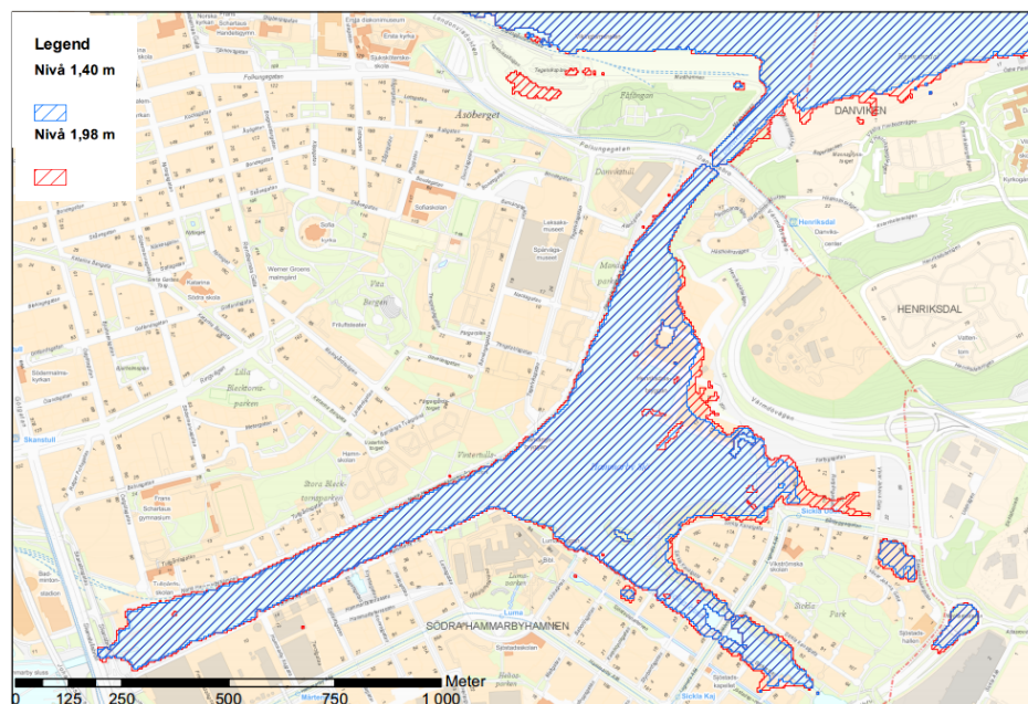
Figur 29 Översvämningsskartering Hammarbyhamnen. Källa Stockholms stad
