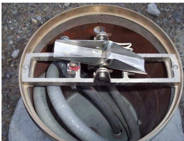
Figur 4. Tipping-bucket nederbördsjälmätare för automatisk nederbördsjälmätning. Bild http://science20.com .
