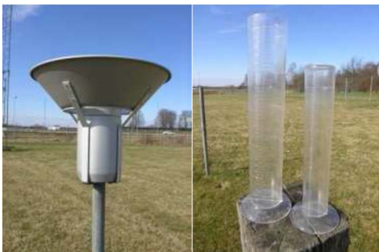
Figur 2. Traditionell nederbördsmätare med vindskydd typ nipher för manuell nederbördsmätning till vänster och mätglas för att mäta mängden nederbörd till höger. Bilder från SMHI.
