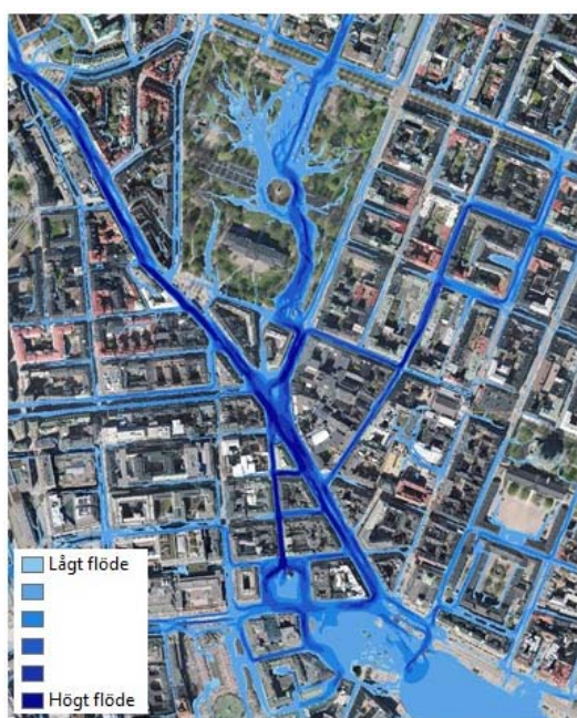
Figur 4 Resultat från modellering befintliga förhållanden, maximala flöden under simuleringen.
