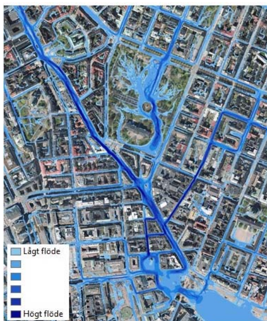
Figur 10 Resultat av modellering med åtgärder, maximala flöden under simuleringen.
