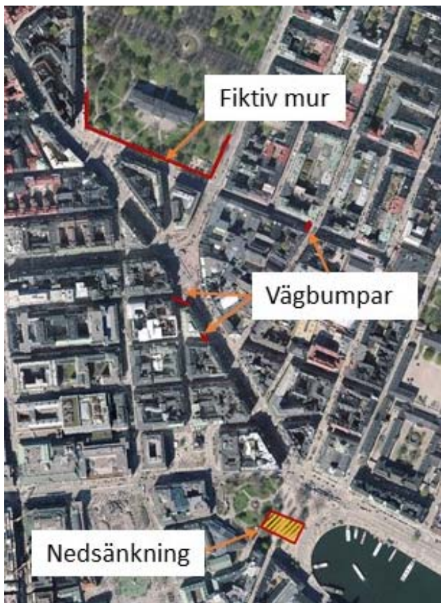
Figur 8 Placering av åtgärder i skyfallsmodellen.
