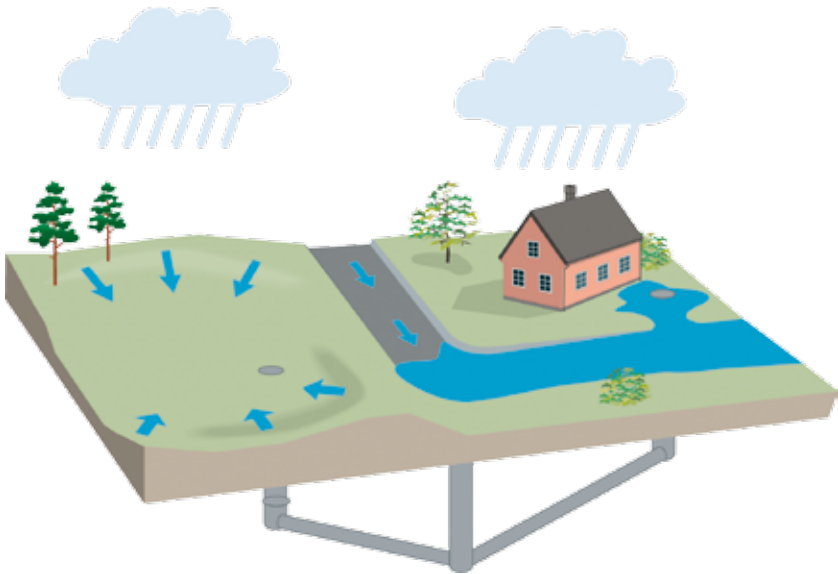
Figur 6. Principen för kartering av markavrinning och ledningsnät. Markavrinningsmodellen kopplas till en ledningsnätsmodell som beskriver de lokala kapacitetsförhållandena i ledningsnätet. Beräknad översvämning kan bli både mindre och större jämfört med en ren kartering av markavrinning. I den vänstra lågpunkten sväljer ledningsnätet all tillrinning och översvämning uteblir. Ledningsnätet längs vägen överbelastas och bidrar med ytterligare vatten som rinner ut från brunnar, vilket ökar översvämningens omfattning längs vägen.
