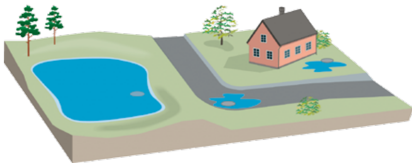
Figur 4. Principen för kartering av lågpunkter. Alla lågpunkter i terrängen fylls med vatten utan hänsyn till regnets storlek. Ingen hänsyn tas till markavrinning och ledningsnät.
