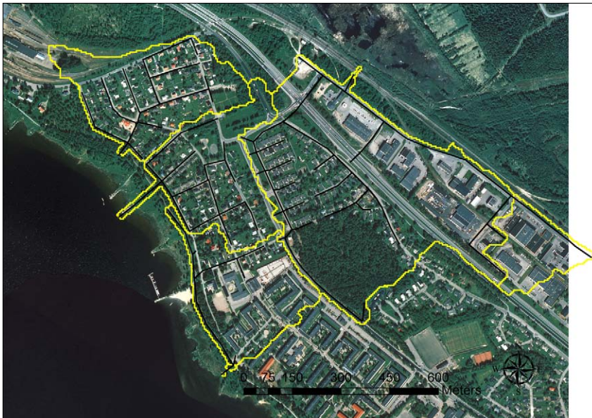
Figur 3-5 Tillämpningsområdet i Notviken, Luleå. Begränsning för delavrinningsområden samt ledningsnätmodellens sträckning visas.
