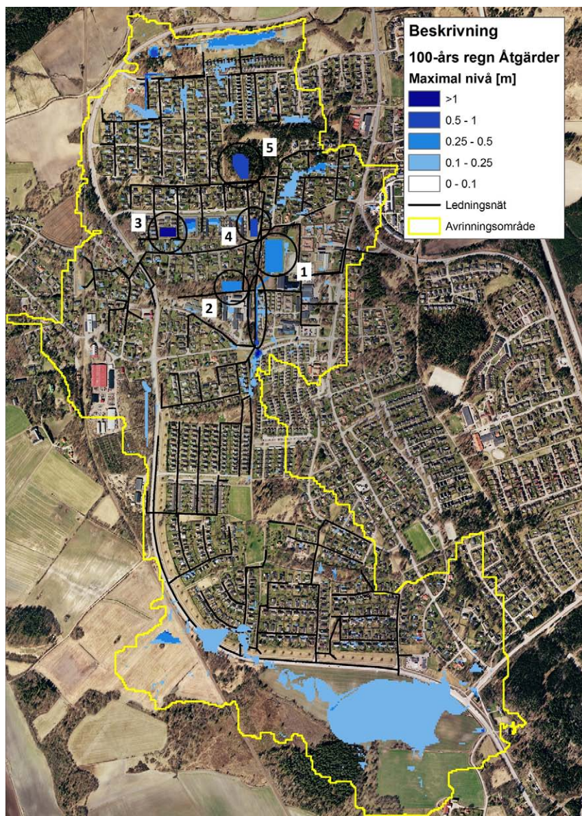
Figur 4-7 Maximala vattennivåer på markytan vid ett 100-årsregn i Lindsdal (med Plan B-åtgärder inringade och översvämningsytor numrerade).
