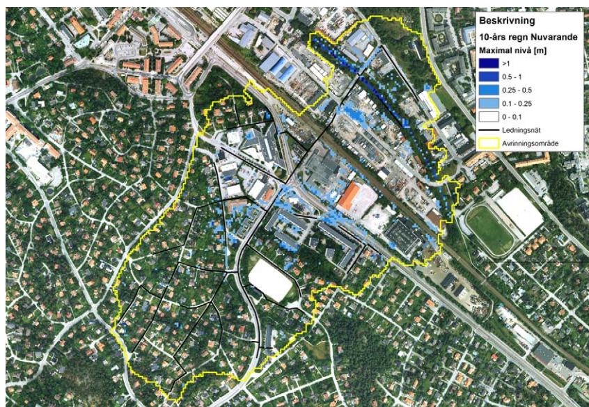
Figur 4-13 Maximala vattennivåer på markytan vid ett 10-årsregn i Bromsten (nuvarande situation).
