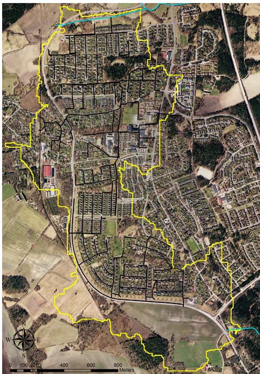
Figur 3-3 Tillämpningsområdet i Lindsdal, Kalmar. Begränsning för avrinningsområde samt ledningsnätets sträckning visas.
