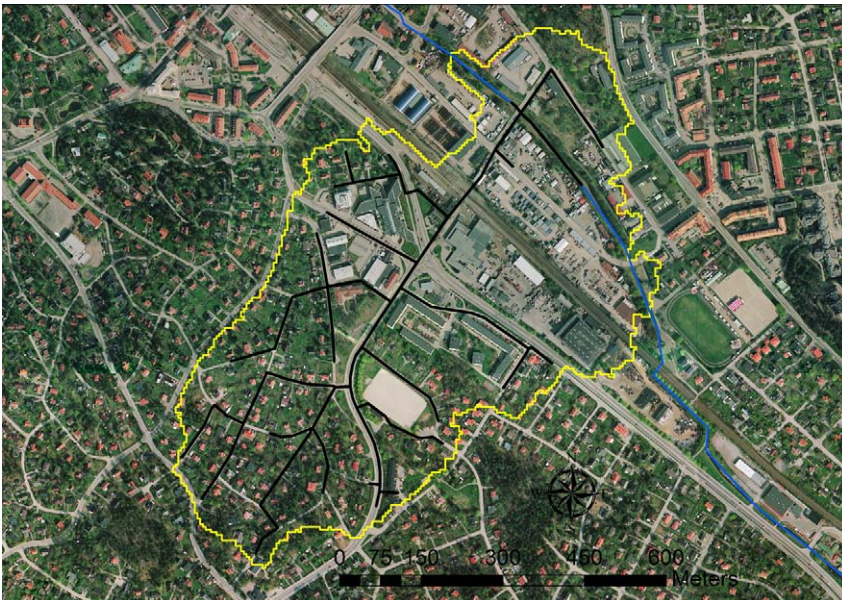
Figur 3-7 Tillämpningsområdet i Bromsten, Stockholm. Begränsning för avrinningsområde, Bällstaåns sträckning samt ledningsnätmodellens sträckning visas.
