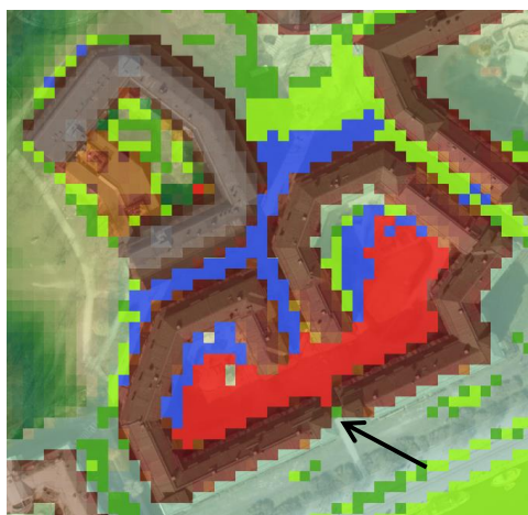
Figur 1 Instängt område pga gridstorleken i terrängmodellen, i detta fall vid Färgårdstorget på Södermalm.
