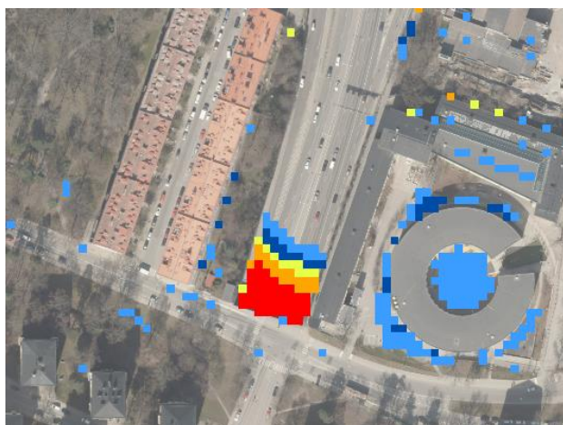
Figur 2 Ansamling av vatten vid öppningen till en tunnel, i detta fall Essingeleden vid Fredhäll.
