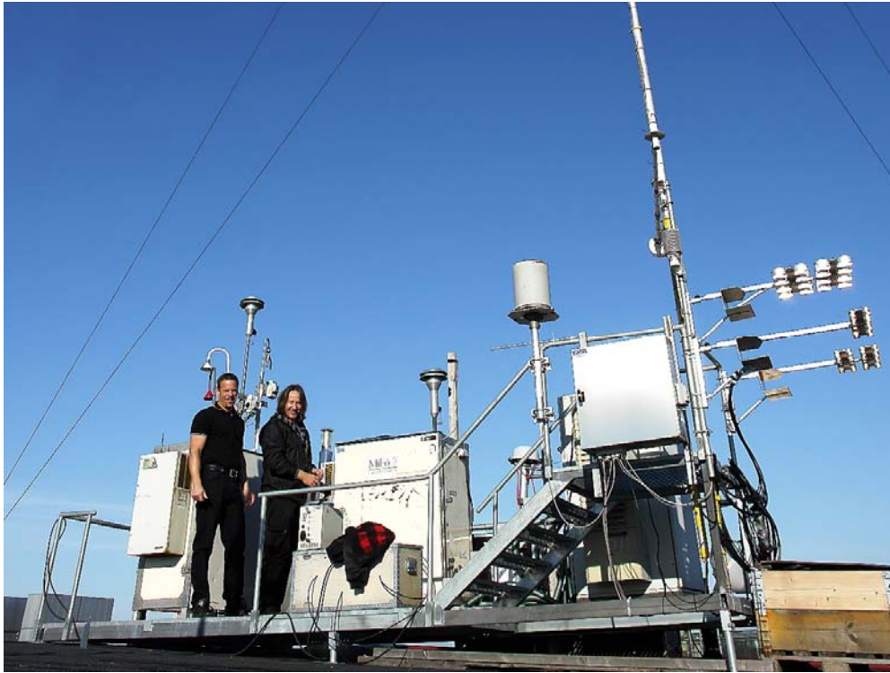
Figur 3. Meteorologisk mätstation vid Torkel Knutssonsgatan, belägen på ett tak på Södermalm i Stockholms innerstad. Temperaturmätaren är placerad 20 m ovan mark.
