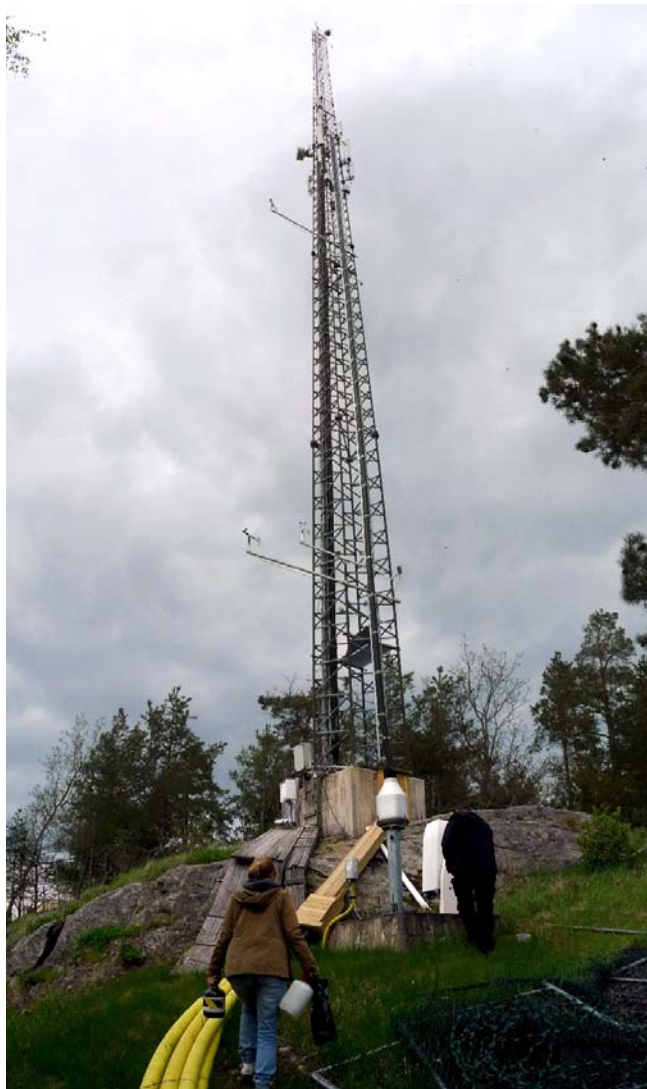
Figur 2. Meteorologisk mast belägen i området Högdalen i södra Stockholm. Temperaturmätaren är placerad 5 m ovan mark.
