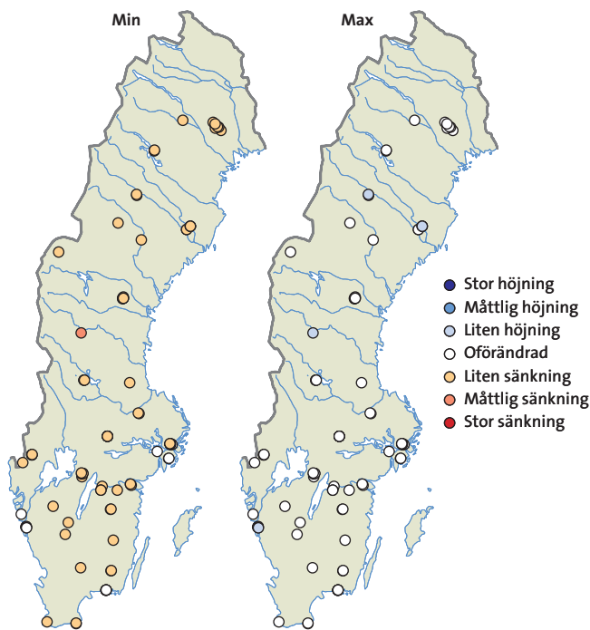
Figur 16. Skillnad mellan högsta och lägsta grundvattennivåskillnad för morän under sommaren för utsläppsscenarioet RCP 8,5, perioden 2069–2098. Skillnaderna mellan lägsta (till vänster) och högsta (till höger) är mindre jämfört med våren och skillnaderna är även mer jämnt fördelade i förhållande till referensperioden.
