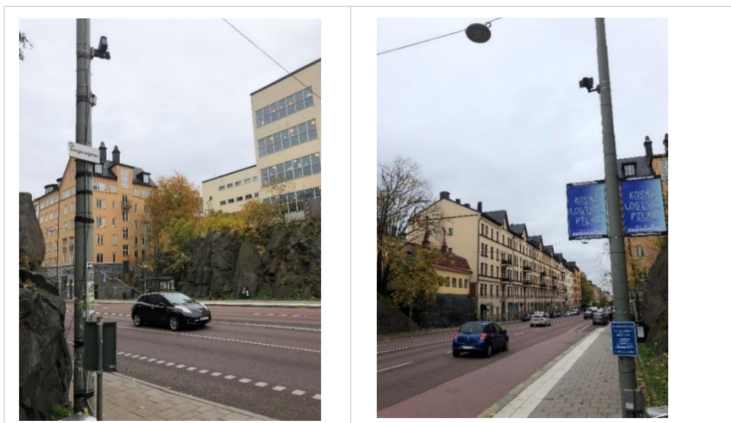
Figur 3. Placering av sensorer för avläsning av fordonens registreringskyltar per körriktning på Hornsgatan i höjd med Ansgariegatan. Facility Labs AB.
