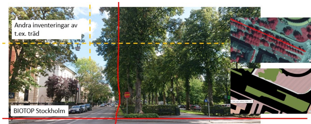
Figur 1 Bilden visar skillnaden mellan BIOTOP SE:s gränsdragning mellan styrande masker, i det här fallet infrastrukturen, och annan information. I de fall då gränsen är mot hög vegetation (>5 m) innebär det att de överhängande trädkronorna klipps bort. Detta leder i sin tur till att många trädklädda ytor i staden kan kännas underrepresenterade och att smala alléer ofta försvinner under minsta karteringsenheten.
