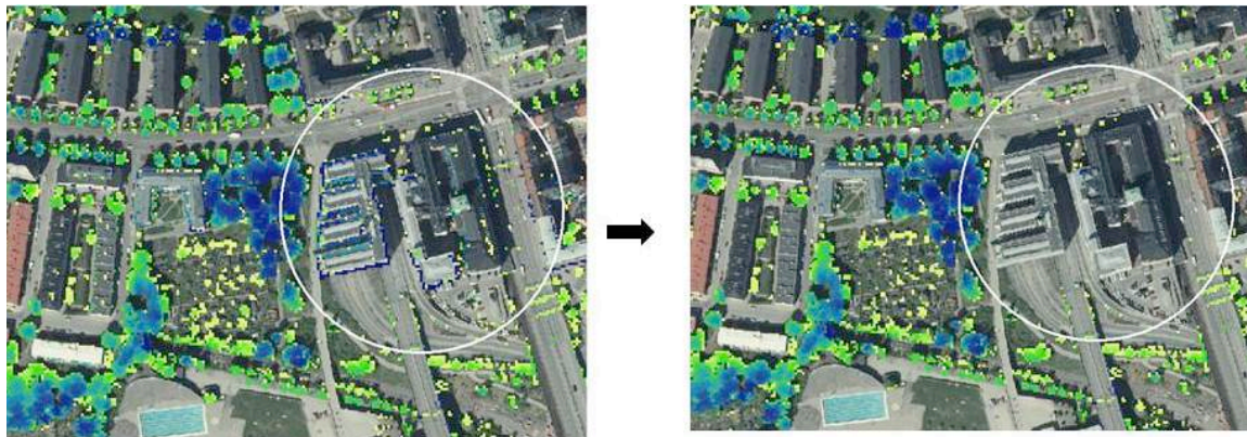
Figur 3. Filtrering av vegetationspixlar i vegetationshöjdsrastret. Ofiltrerat raster till vänster och filtrerat raster till höger. För att undvika att förlora trädalléer tätt intill byggnader gjordes en mindre buffert kring byggnaderna vilket medför att en del pixlar intill byggnadsfasader fortfarande räknas in som vegetationspixlar.
