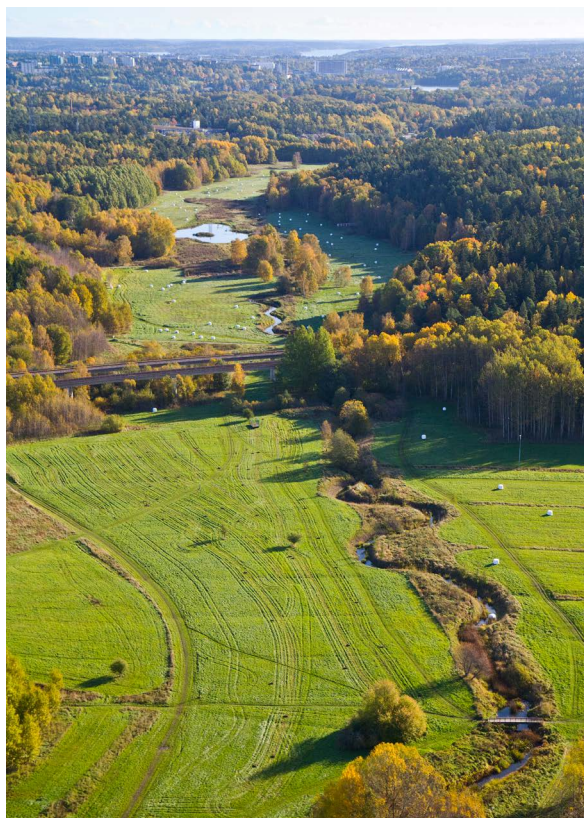
Fig 5. Flygfoto över Igelbäcken inom Solna och Sundbyberg stad. Inom området på fotot har bäcken grävts om från ett tidigare rakt dike till ett vattendrag med mer naturliga meandringar och tillförts nytt bottenstrat i form av sten och block. De senaste åren har dock de restaurerade strömsträckorna på bilden dämpats av bävrar, som framgångsrikt etablerat sig i området. Foto med tillstånd från Solna stad.
