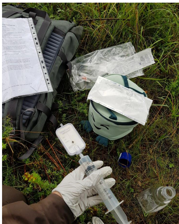
Figur 12. Filtrering av vattenprover genom filterkassett enligt metod från CGI (Furustam och Hante 2020).
