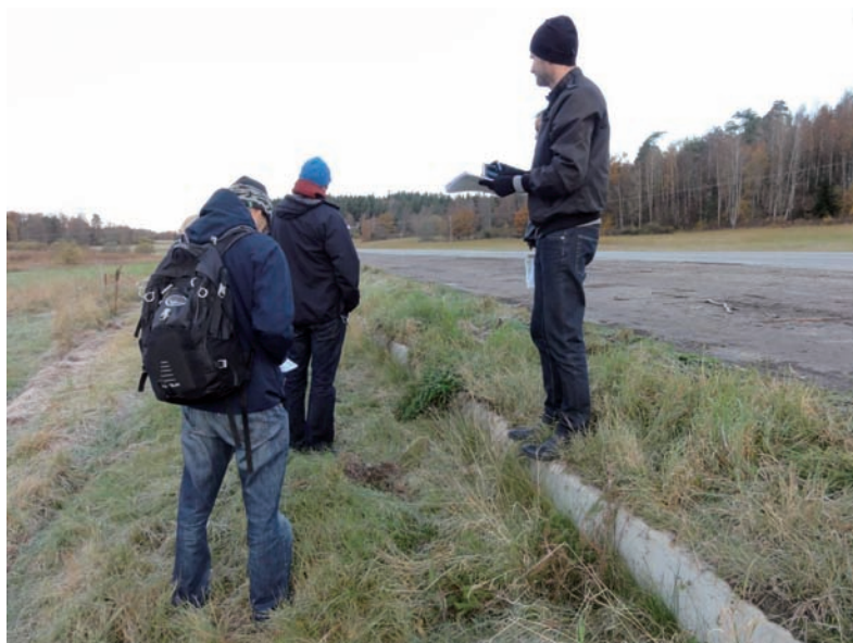
Figur 13. Exempel från Skårsjödammen på hur det kan se ut när vegetationen är för hög. Den ymniga vegetationen kan bidra till att groddjuren klättrar över barriären (bilden är tagen femte oktober 2012). Anläggningen är 7 år gammal.
