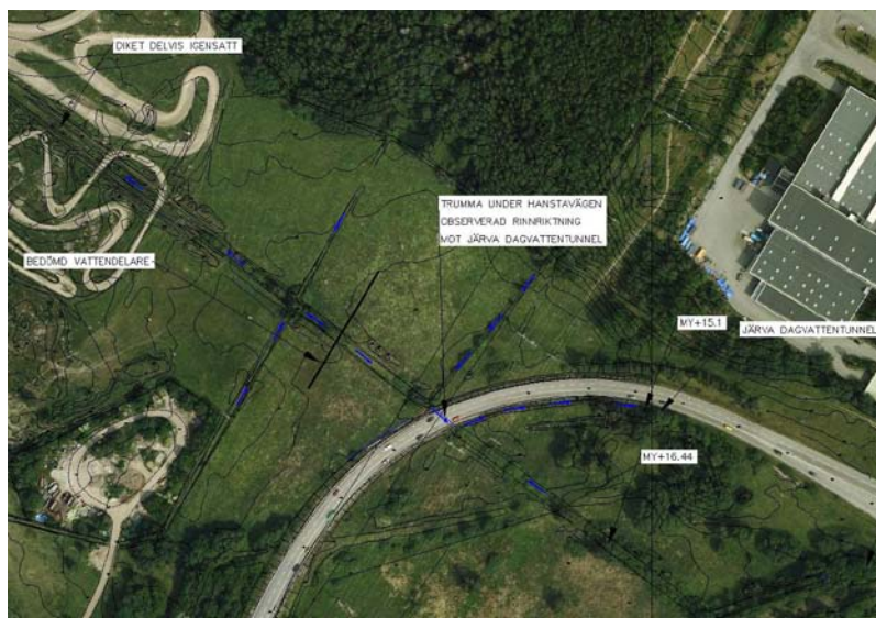
Figur 6. Nuvarande avrinningssituation Stordiket.
