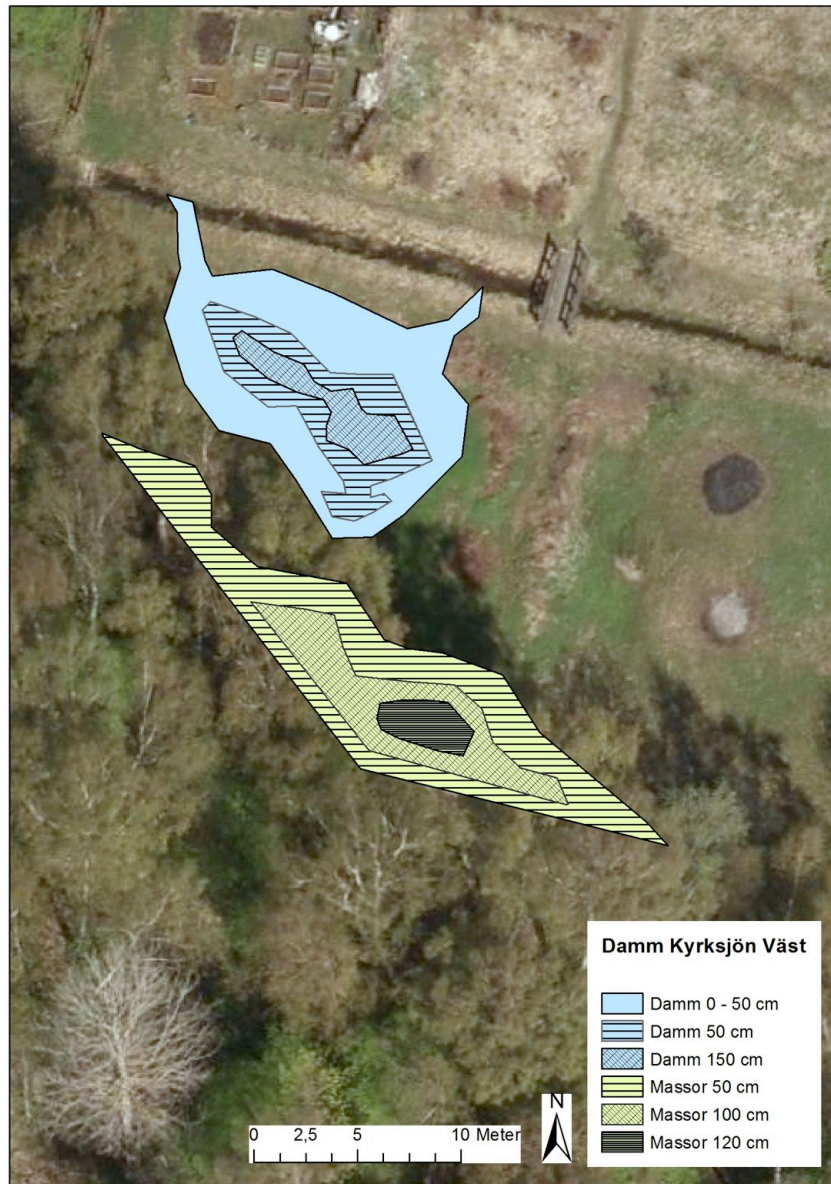
Figur 9 detaljkarta över möjlig damm i västligt läge. Ungefärligt djup och höjd av uppkomna massor enligt teckenförklaring.
