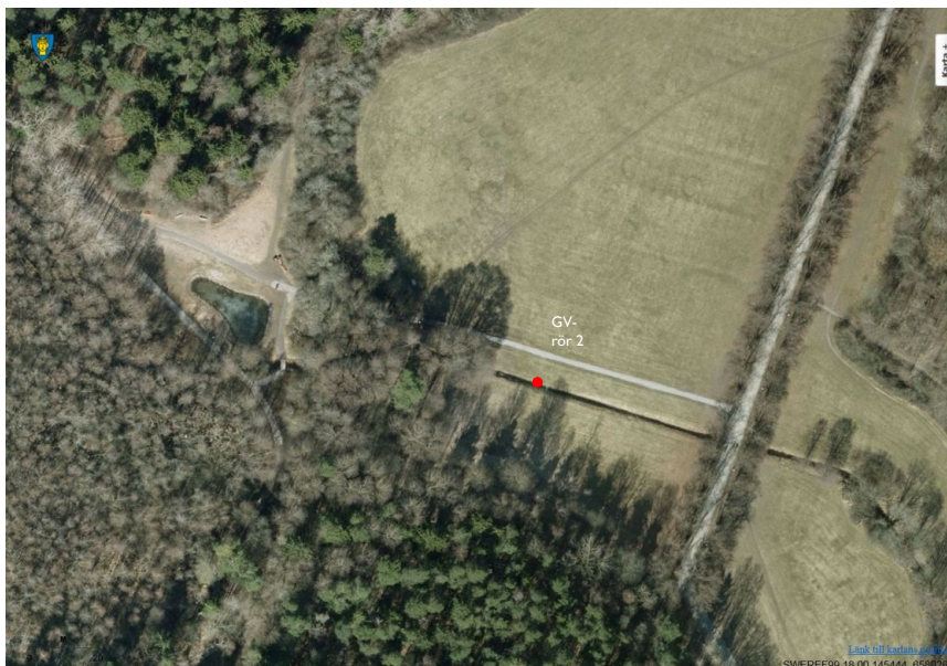
Provpunkt för g.v-rör läge 1 i Judarskogens naturreservat. Avläsning i september gav nivån: -1,1 m.
