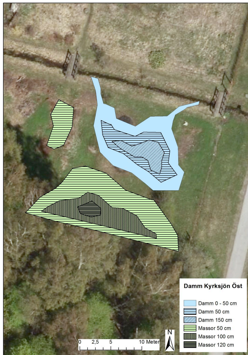
Figur 10 detaljkarta över möjlig damm i östligt läge. Ungefärligt djup och höjd av uppkomna massor enligt teckenförklaring.
