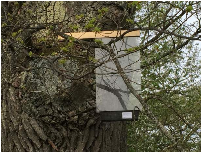
Figur 4. Bilden visar en fönsterfälla. Flygande insekter krockar med plexiglasskivan och ramlar ner i behållaren.
