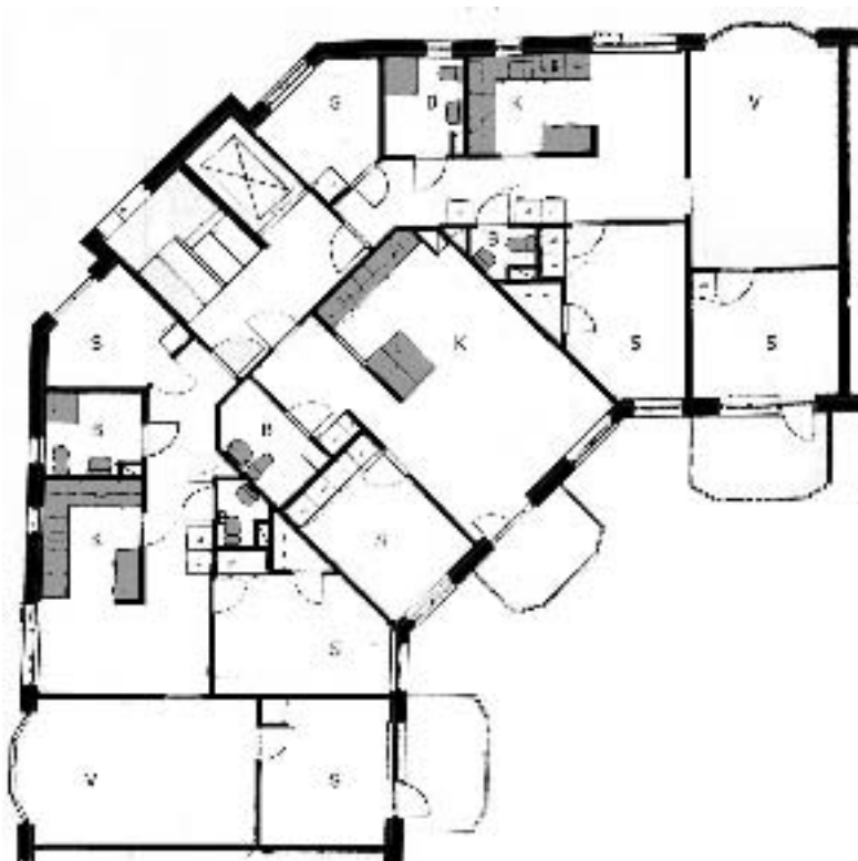
Avfasat hörn med trapphuset i hörnet, trespännare.
