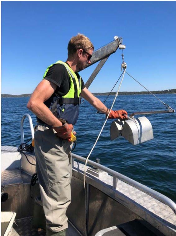
Figur 4. Callunas personal Magnus Tillström förbereder van Veen-huggaren för provtagning 2020.
