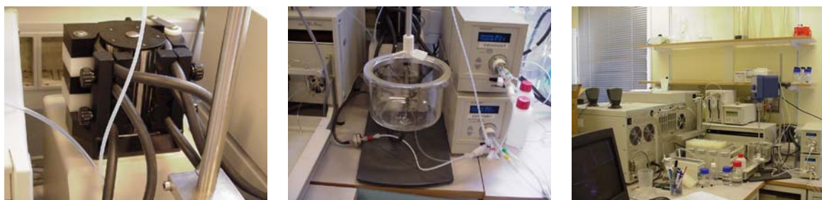
Bild 4. ASPEC – pump – provkärl och själva roboten.
