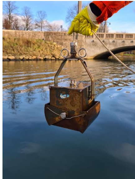
Figur 2. Foto av en ekmanhuggare som användes vid provtagningen av djupa bottenar.
