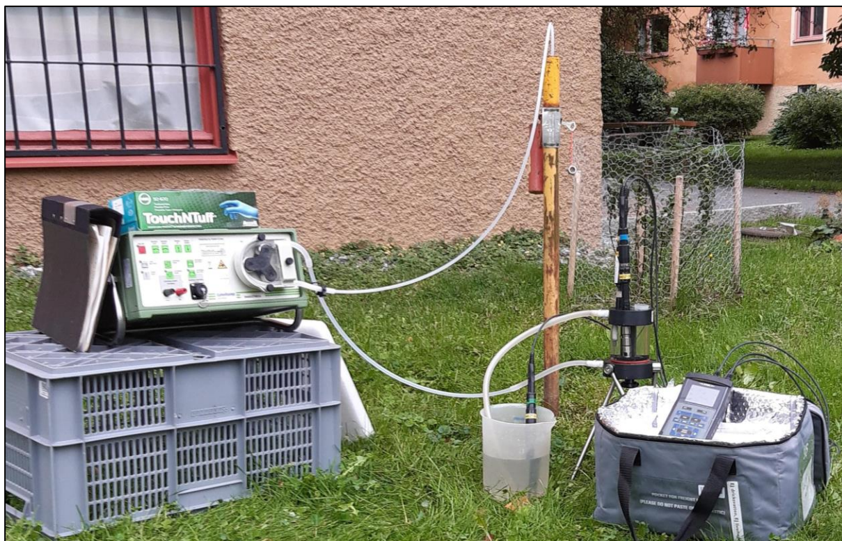
Foto 2. Utrustning för omsättning och fältmätning vid grundvattenprovtagningen i Stockholms stad hösten 2022.
