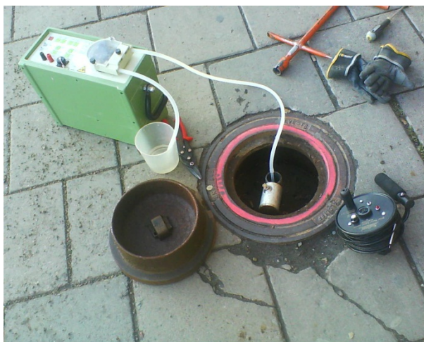
Figur 2. Provtagningsutrustning för provtagningen i nivå-rör, i nivå-rör under däcksel (till vänster), i den vanligaste typen av nivå-rör (till höger) och i miljörör (nedan).
