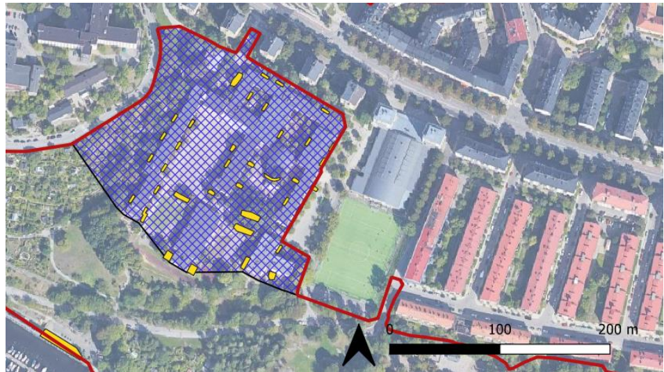
Figur 7. Tillrinningsområdet för dagvatten (blått), ett principförslag för placering och storlek på åtgärdsytor (gult) samt möjlig placering av en 300 kvadratmeter stor skärmbassäng (gult).
