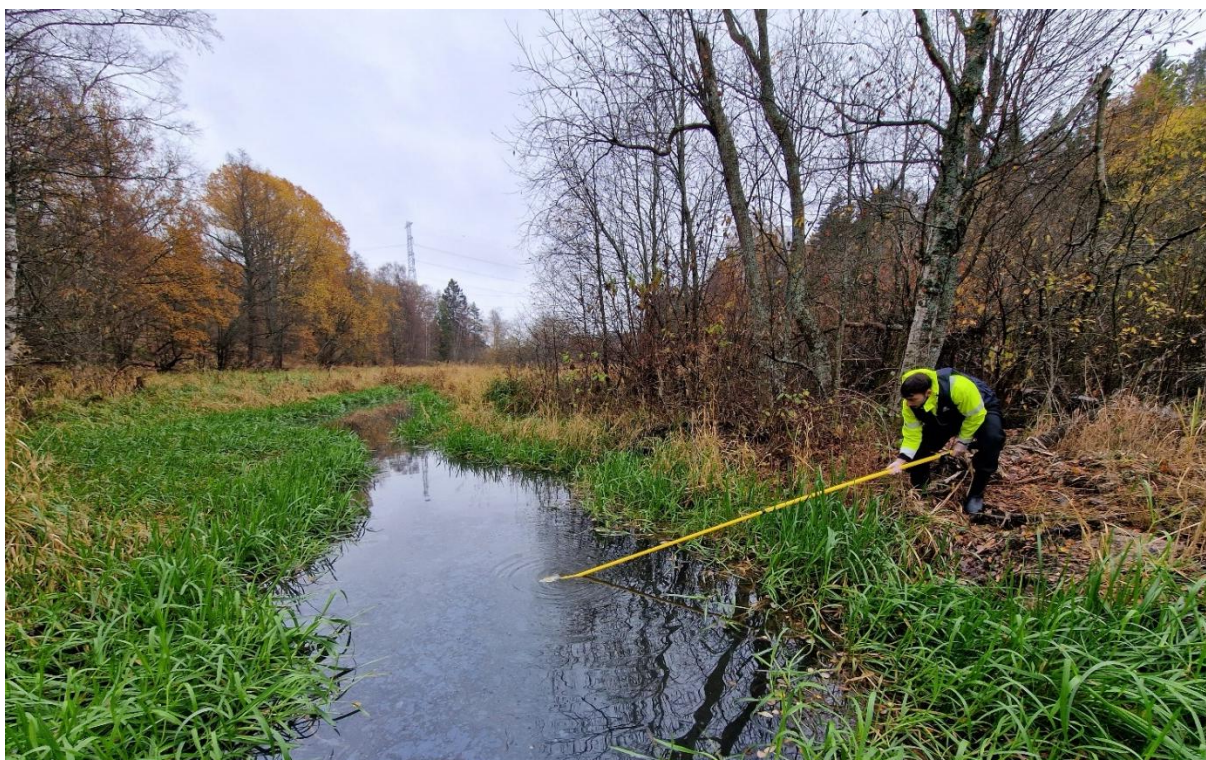
Figur 8. Provtagning av ytvatten med en swing sampler. Bilden är tagen uppströms Magelungsdiket. Foto: Marko Filipovic, Sellén & Filipovic AB.
