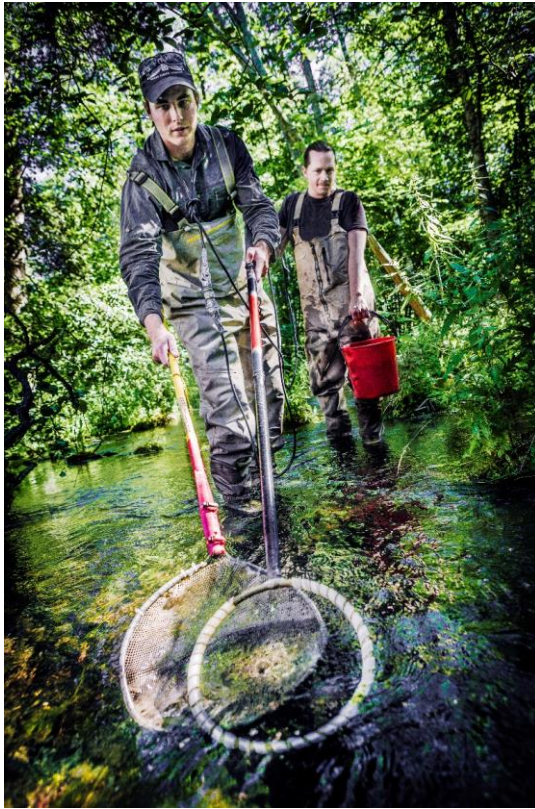
Figur 3: Bilden visar hur ett elfiske bedrivs praktiskt. Pluspolen (anoden) är den runda ringen i bild.
