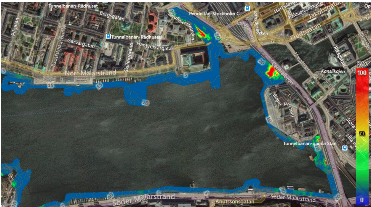
Figur 12. Undervattensvegetationens biovolym var hög (> 75 %) i delområden vid Karlbergskanalen utanför Stadshuset samt invid Centralbron, Riddarfjärden. Biovolym anges som den andel av vattenpelaren som tas upp av vattenvegetation (rött=100%, gult=50%, blått=0%, ingen vegetation). Kartan har framställts via BioBase. Djupkurvor indikeras i fot.
