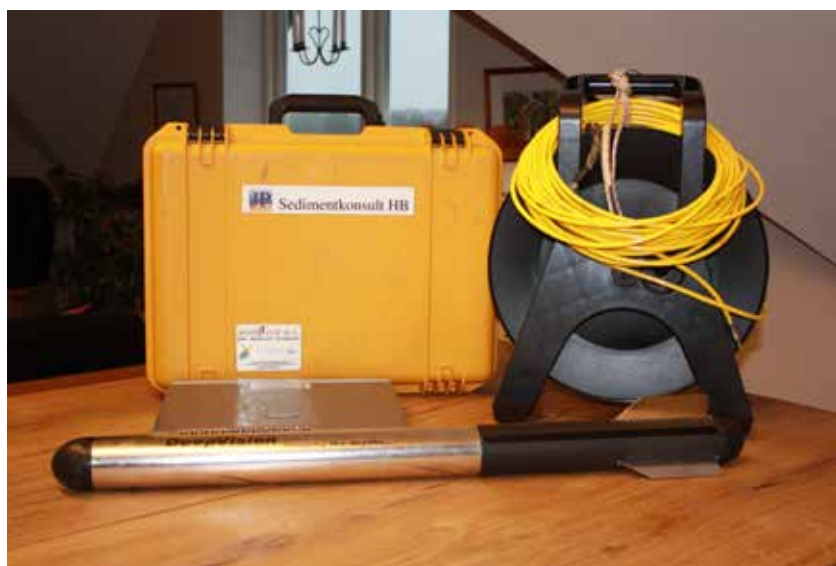
Figur 2. Portabel side scan sonar av typ DeepVision (340 KHz).
