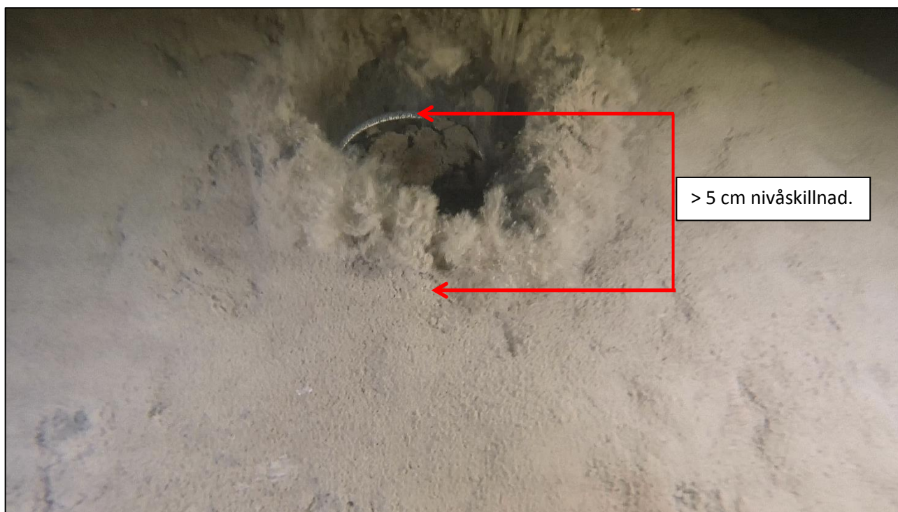
Figur 5 - Dokumentation av provtagningsförloppet. Bilden visar hur akrylröret skär ned i sedimentet innan själva provtagningsmekanismen aktiverats vilket i värsta fall leder till att de översta lagren riskerar att komprimeras alternativt tryckas åt sidan med störning i kärnans lagerföljd som resultat. I sammanhanget bör nämnas att störningen som syns i bilden uppstår trots att provtagaren sänkts ned med mycket stor försiktighet.
