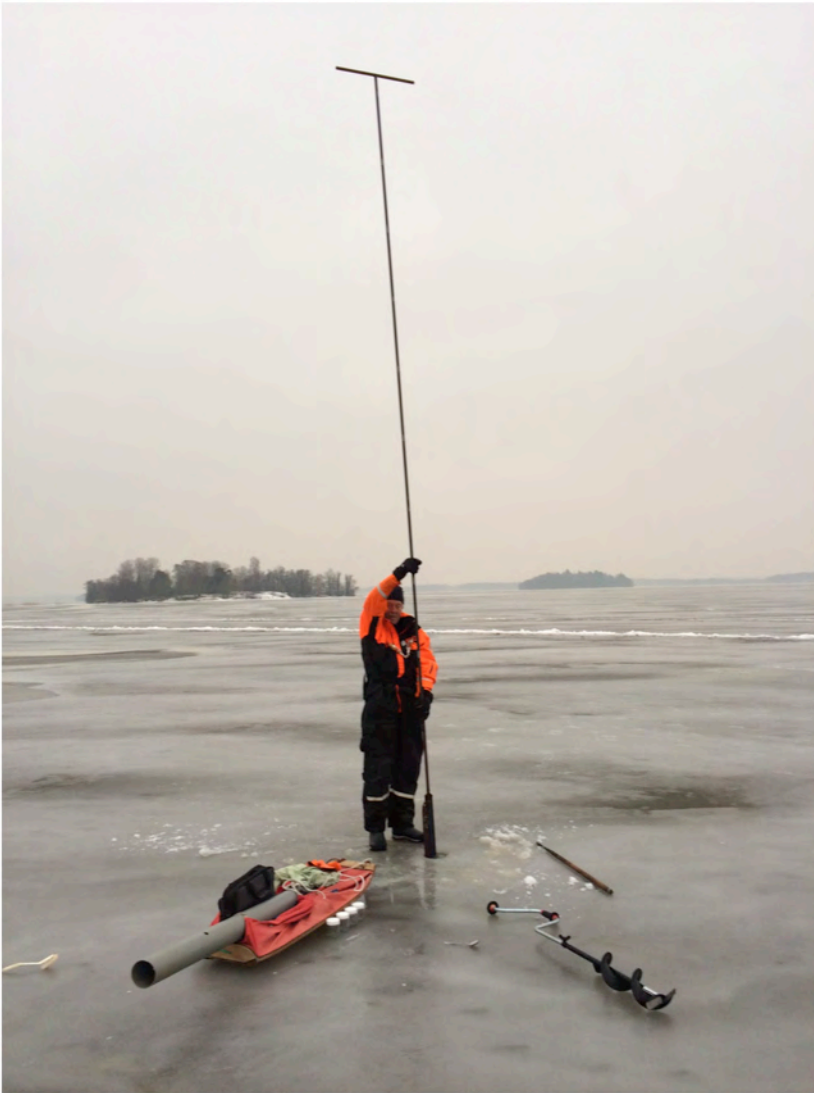
Figur 5 Provtagning med Rysskannborr från Västeråsfjärdens is 2014
