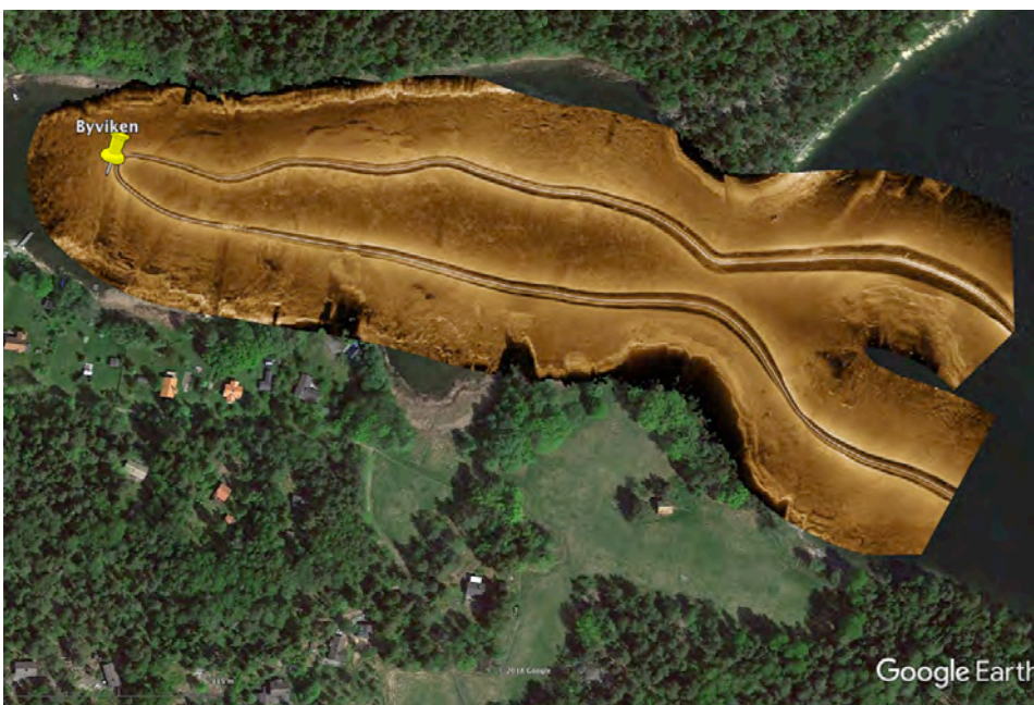
Figur 11 Undersökningsområdet Byviken vid Gällnö med inlagd provtagningsstation och sonar-plott.
