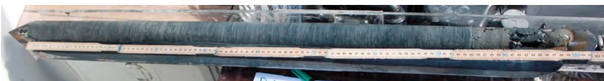
Figur 6 Rysskannborr som lagts i ett halvt sedimentprovtagningsrör och sedan öppnats och preparerats för dokumentation och provtagning.
