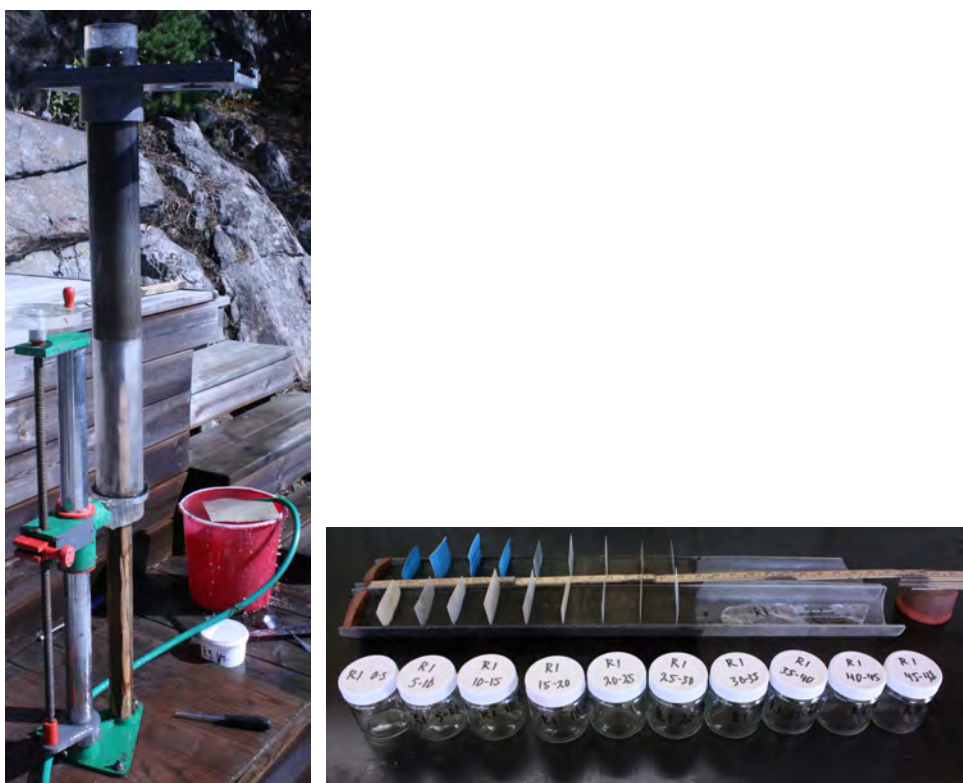
Figur 6 Vänster: Direkt snittning av Gemini-kärna. Höger: Provtagning av utskjuten Geminikärna.
