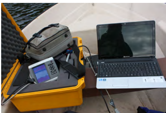
Figur 1 a/ Provtagningsbåten Rana b/ Side scan sonar och djupekolod i Rana.
