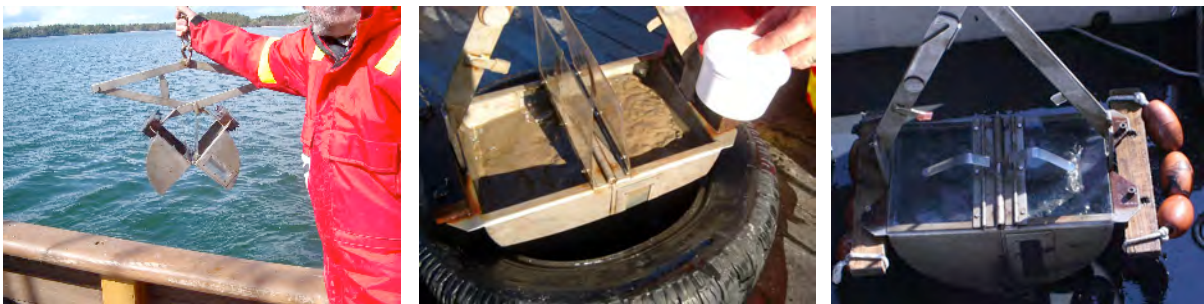
Figur 4 Vänster: Ponarhämtaren laddad och redo för hugg. Mitt: Uttagning av ytsedimentprover. Höger: Utan tyngder och med flytkroppar.
