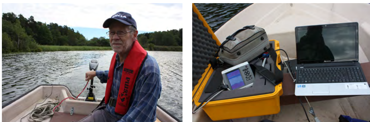
Figur 1 a/ Provtagningsbåten Rana b/ Side scan sonar och djupekolod i Rana.
