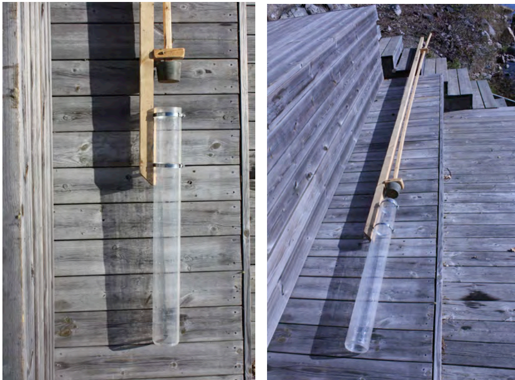
Figur 5 Den nyutvecklade Jonsson-hämtaren (Jonsson 2016).
