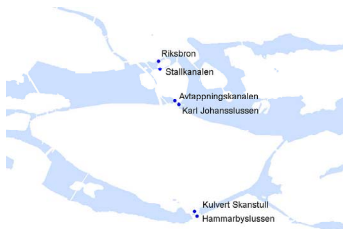
Figur-A4:1. Utskov för vatten från Mälaren till Saltsjön. Den största transporten sker genom Norrström och den närbelägna Stallkanalen (källa: Hans Bergström, Stockholms hamn).
