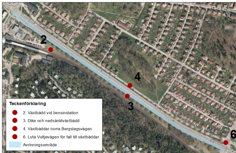
Figur 15 - Avrinningsområde till åtgärdsförslag 3 bestående av dike och växtbäddar längs med södra sidan av Bergslagsvägen.
