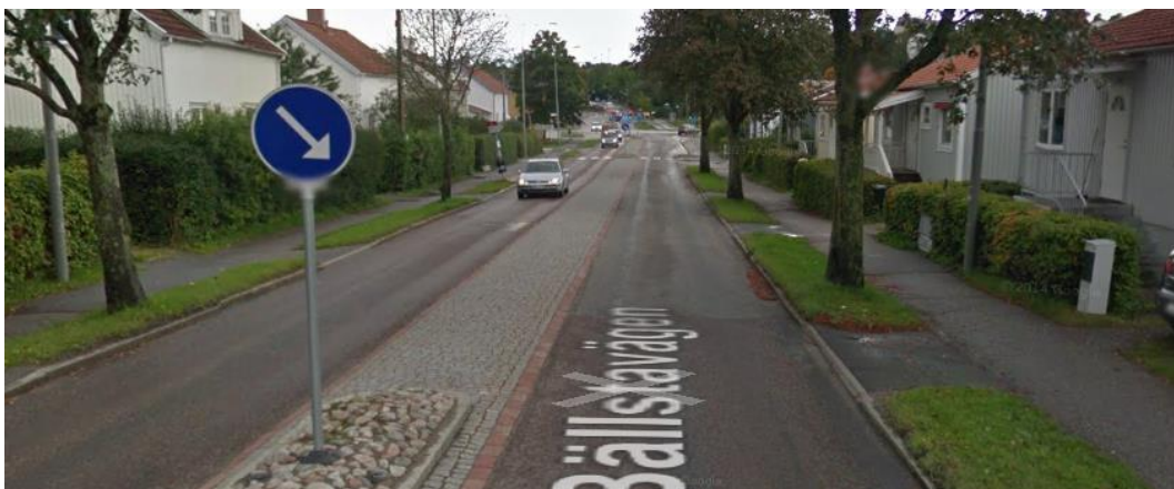
Figur 9 - Bällstavägen med gräsytor på vardera sida av vägen där nedsänkta växtbäddar skulle kunna placeras för att ta hand om framförallt vägdagvattnet.
