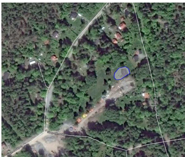
Figur 25. Illustration av ytbehov och möjlig placering av dagvattendamm vid Högmoravägen på 0,04 hektar (våtyta), vilket motsvarar cirka 1 % av avrinningsområdets reducerade yta. Foto från Google Earth.
