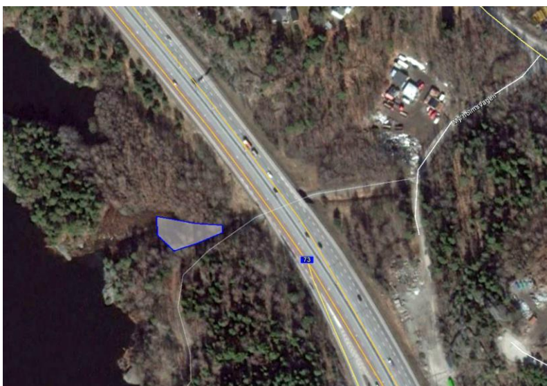
Figur 21. Illustration av ytbehov och ungefärlig placering av dagvattendamm vid Linatorpsvägen på knapp 0,1 hektar (våtyta), vilket motsvarar cirka 1 % av avrinningsområdets reducerade yta. Foto från Google Earth.
