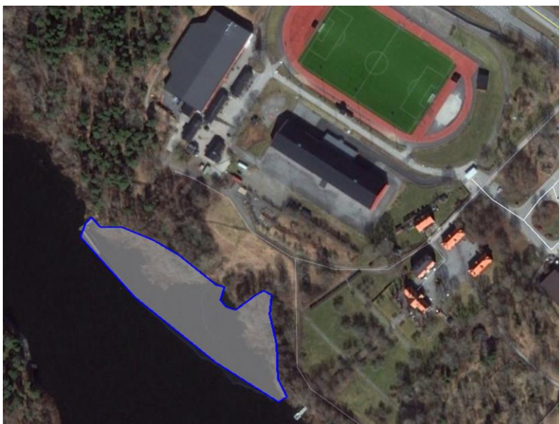
Figur 9. Illustration av den befintliga skärmbassängen vid Farsta IP. Ytan på knappt 0,9 hektar motsvarar cirka 2,5 % av avrinningsområdets reducerade yta. Inpassning gjord mot tätortskartan vars strandlinje tycks skilja sig något mot hur den ter sig på flygfotot i figuren. Foto från Google Earth.
