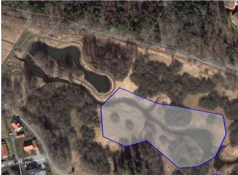
Figur 3. Illustration av möjlig utvidgning av Kräppla våtmark med 1,1 hektar (våtyta), vilket skulle innebära att anläggningens hela yta motsvarade 1,5 % av avrinningsområdets reducerade yta. Foto från Google Earth.
