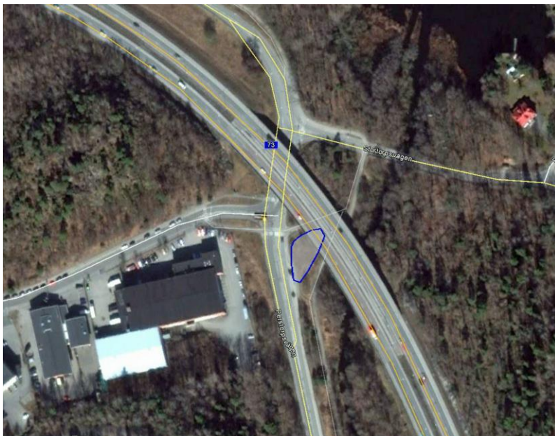
Figur 19. Illustration av ytbehov och ungefärlig placering av dagvattendamm/dagvattenmagasin vid Edsvallabacken på knapp 0,1 hektar (våtyta), vilket motsvarar cirka 1 % av avrinningsområdets reducerade yta. Foto från Google Earth.
