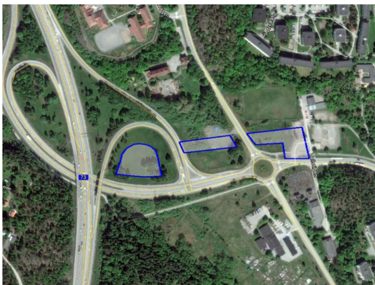
Figur 5. Förslag till placering av dagvattendamm vid Skogås entré på cirka 0,4 hektar våtyta (västra ytan), vilket motsvarar cirka 1 % av avrinningsområdets reducerade yta. De två ytorna i öster är delvis planlagda för behandling av dagvatten från det nya planområdet. Foto: Google Earth.
