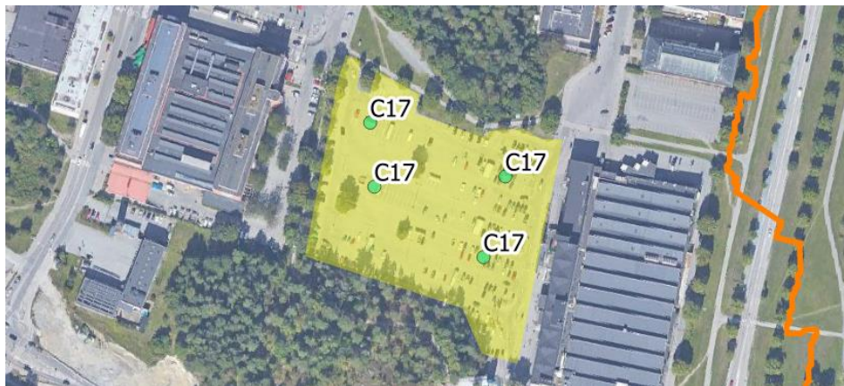
Figur 19. Åtgärd C17 (grön yta), avrinningsområde till växtbäddar (gul yta) och gräns för tillrinningsområdet till Räcksta träsk (orange linje). Figur baserat på GIS-underlag från Sweco 2017, se referenser.
