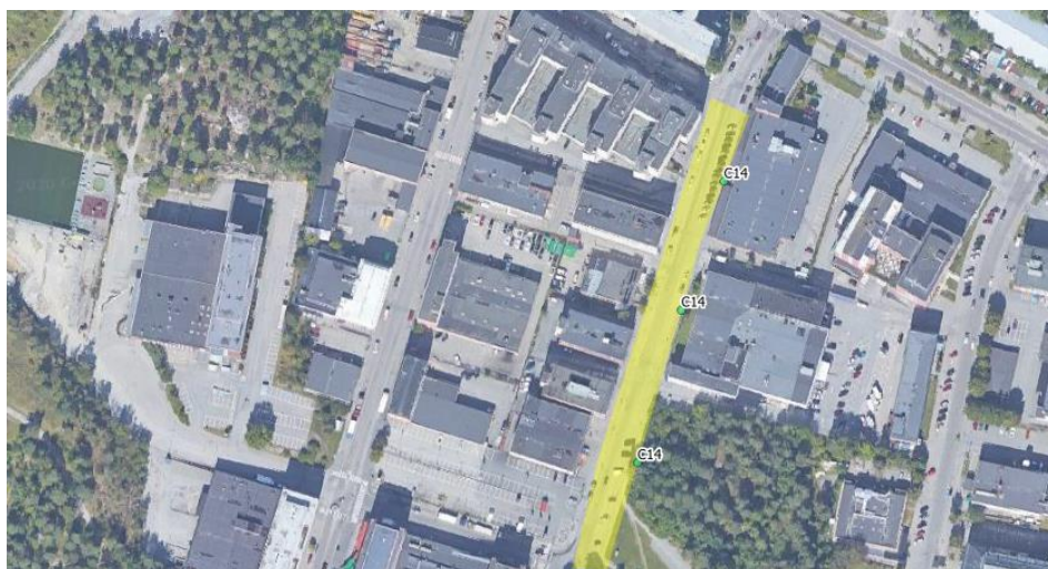
Figur 16. Åtgärd C14 (grön yta), avrinningsområde till växtbäddar (gul yta) och gräns för tillrinningsområdet till Räcksta trask (orange linje). Figur baserat på GIS-underlag från Sweco 2017, se referenser.
