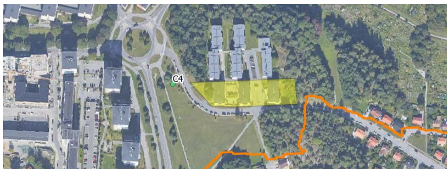
Figur 5. Avrinningsområdet som leds till växtbädd är markerat i gult, läget för växtbädden är markerat med grön punkt. Gränsen för tillrinningsområdet för Räcksta träsk är markerat med orange linje. Figur baserat på GIS-underlag från Sweco 2017, se referenser.
