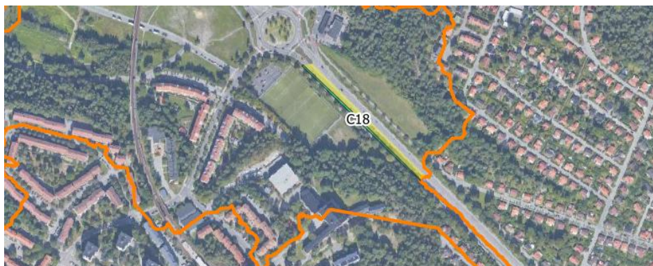
Figur 20. Åtgärd C18 (grön yta), avrinningsområde till dike (gul yta) och gräns för tillrinningsområdet till Räcksta träsk (orange linje). Figur baserat på GIS-underlag från Sweco 2017, se referenser.
