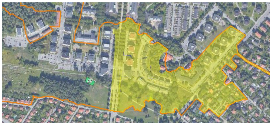
Figur 8. Åtgärd C7 (grön yta), avrinningsområde till avsättningsmagasin (gul yta) och gräns för tillrinningsområdet till Räcksta träsk (orange linje). Figur baserat på GIS-underlag från Sweco 2017, se referenser.
