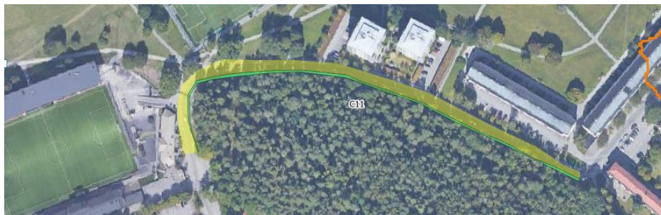
Figur 13. Åtgärd C11 (grön yta), avrinningsområde till dike (gul yta) och gräns för tillrinningsområdet till Räcksta träsk (orange linje). Figur baserat på GIS-underlag från Sweco 2017, se referenser.
