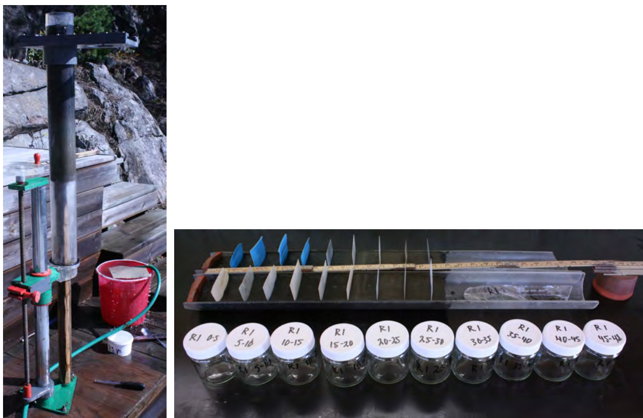
Figur 8 Vänster: Direkt snittning av Gemini-kärna. Höger: Provtagning av utskjutet Geminikärna.
