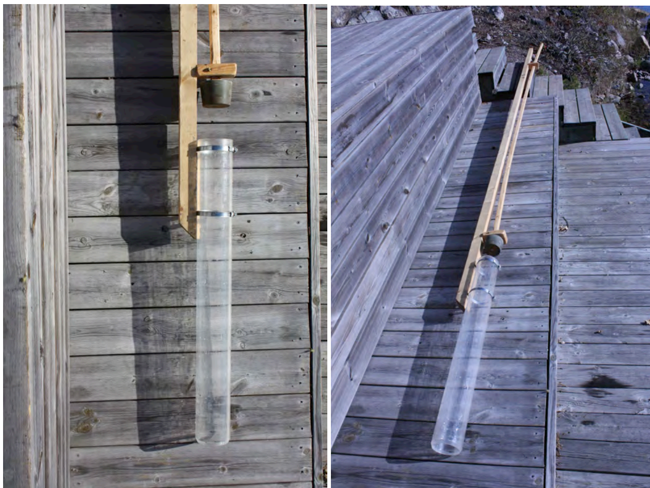
Figur 5 Den för denna undersökning nyutvecklade Jonsson-hämtaren
