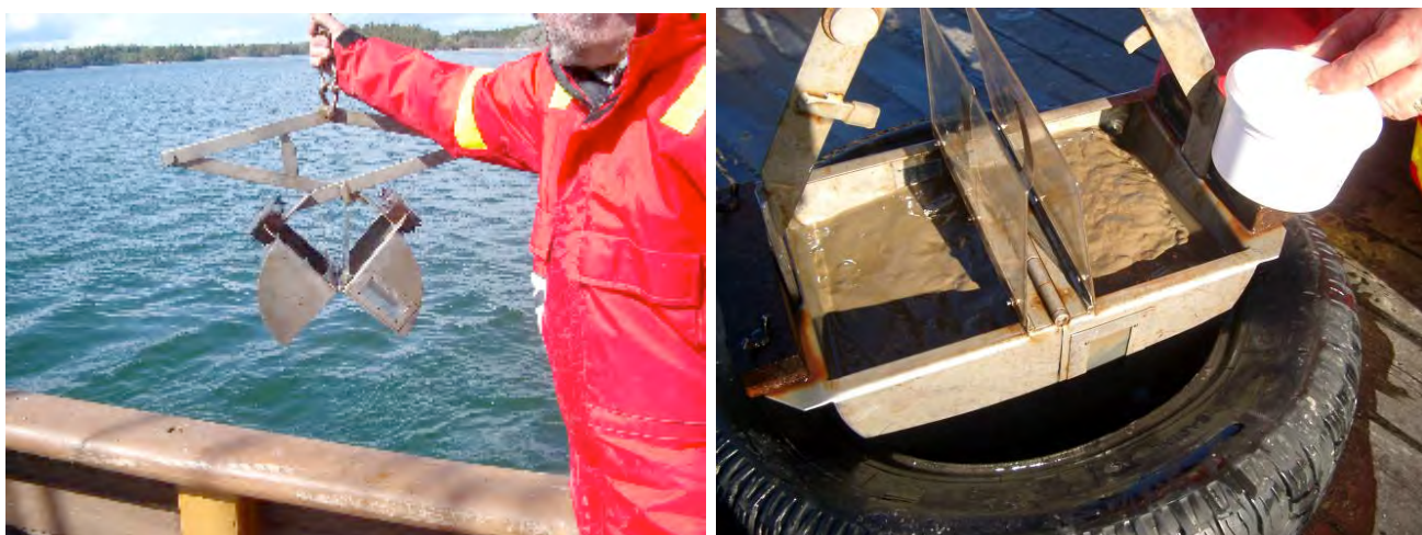
Figur 4 Vänster: Ponarhämtaren laddad och redo för hugg. Höger: Uttagning av ytsedimentprover.
