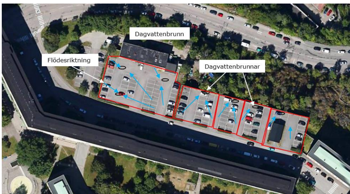
Figur 23. Avrinning och dagvattenbrunnar i område 1. Växtbäddar eller krossdiken anläggs i anslutning till befintliga dagvattenbrunnar.
