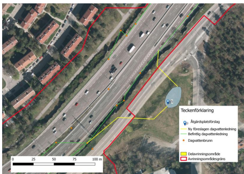
Figur 33. Illustration av ytbehov och ungefärlig placering av en dagvattendamm vid Kontrollvägen på 0,03 ha, vilket motsvarar cirka 1,5 % av avrinningsområdets reducerade yta. Foto Stockholm Stad.
