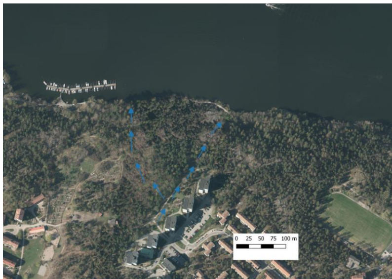
Figur 36. Illustration av två alternativa dragningar för öppen avledning av det idag kulverterade dagvattnet från flerfamiljshusområdet Sköntorp.
