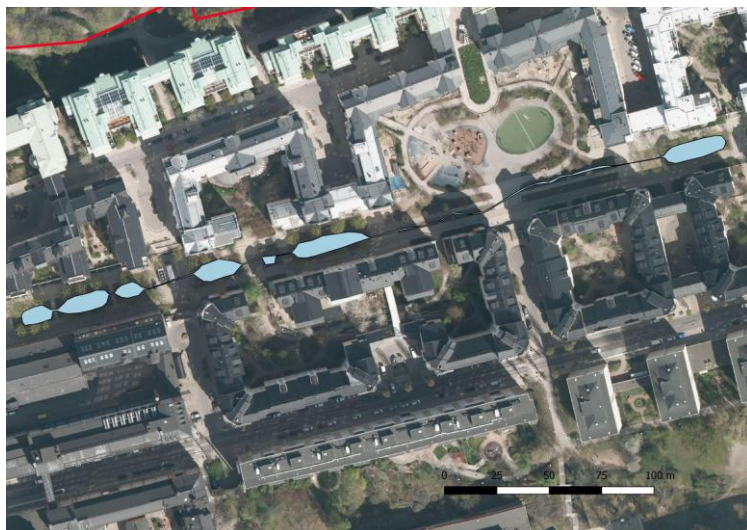
Figur 41. Schematiskt förslag till placering ett dagvattenstråk med flera dammar och bäckar för dagvattenrening och gestaltning utmed Södermalmsallén. Vattnet måste pumpas upp från dagvattenledningen under Södermalmsallén. Foto från Stockholm Stad.
