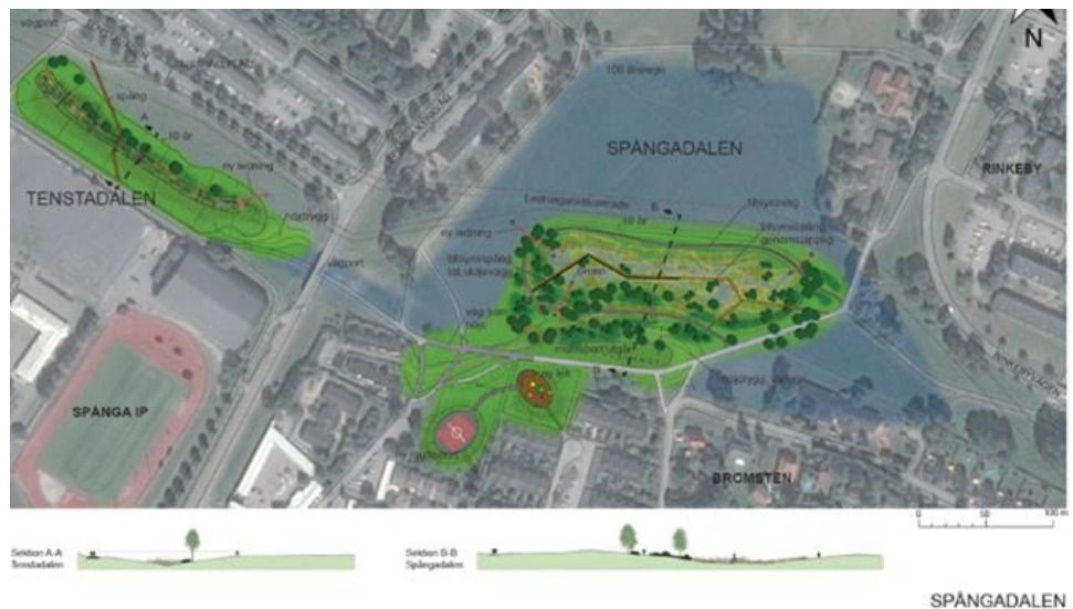
Figur 2. Illustration över dike och torrdammar i Spångadalen
