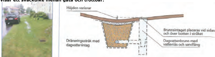
Foto och principfigur på dränerat infiltrationsstråk med upphöjt dagvattenintag. Från Svenskt Vattens publikation "Långsiktigt hållbar dagvattenhantering", P105.
